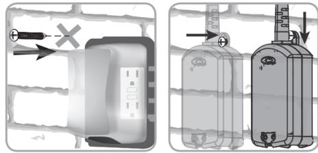
1. Une languette de montage avec trou de vis de type trou de serrure est située sur le dessus de l'appareil. Placez la vis fournie en place à l'endroit voulu, en la laissant dépasser de 3/16 po.
