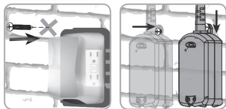
1. En la parte superior de esta unidad se encuentra una lengüeta de montaje con orificio para tornillos. Instale el tornillo incluido en la ubicación deseada con 3/16 de pulgada del tornillo expuesto.
